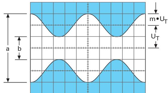
Abb. 2 Amplitudenmodulierte Schwingung:
