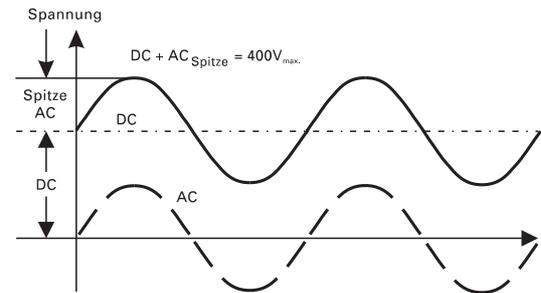
Die gestrichelte Kurve zeigt eine Wechselspannung, die um  $0 Volt$  schwankt. Ist diese Spannung einer Gleichspannung überlagert (DC), so ergibt die Addition der positiven Spitze zur Gleichspannung die maximal auftretende Spannung (DC + AC Spitze).
