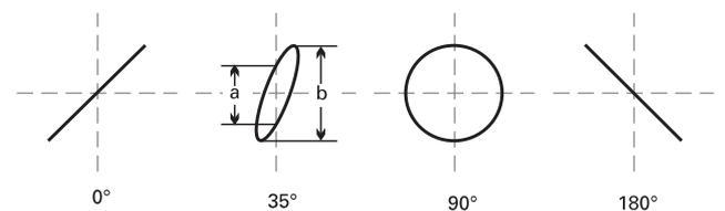
Die Berechnung des Phasenwinkels oder der Phasenverschiebung zwischen den X- und Y-Eingangsspannungen (nach Messung der Strecken a und b am Bildschirm) ist mit den folgenden Formeln und einem Taschenrechner mit Winkelfunktionen ganz einfach und übrigens unabhängig von den Ablenkamplituden auf dem Bildschirm.
