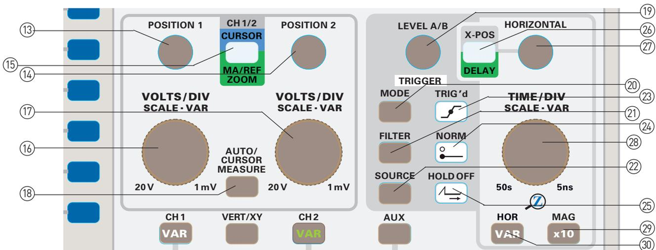
Triggerbedingungen erfüllt hat. Die automatische Triggerrung kann mit und ohne Spitzenwertfassung erfolgen. In beiden Fällen ist der LEVEL A/B-Drehknopf 19 wirksam.
