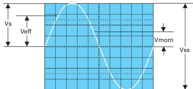
$V_{eff}$  = Effektivwert;  $V_s$  = einfacher Spitzenwert;
