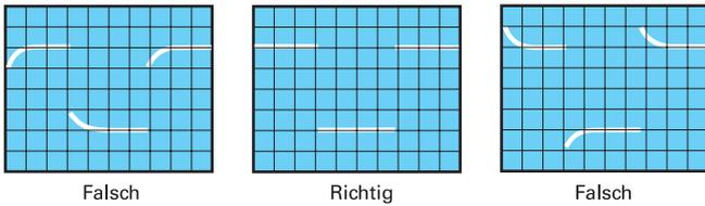
DC stellen, Eingangsteiler (VOLTS/DIV) auf 5mV/cm und Zeitbasis (TIME/DIV) auf 0.2ms/cm schalten (beide kalibriert), Tastkopf (Teiler 10:1) in die „PROBE ADJ“-Buchse einstecken.
