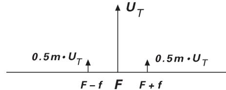
Abb. 1: Spektrumsamplituden und -frequenzen bei AM ( $m = 50\%$ )
